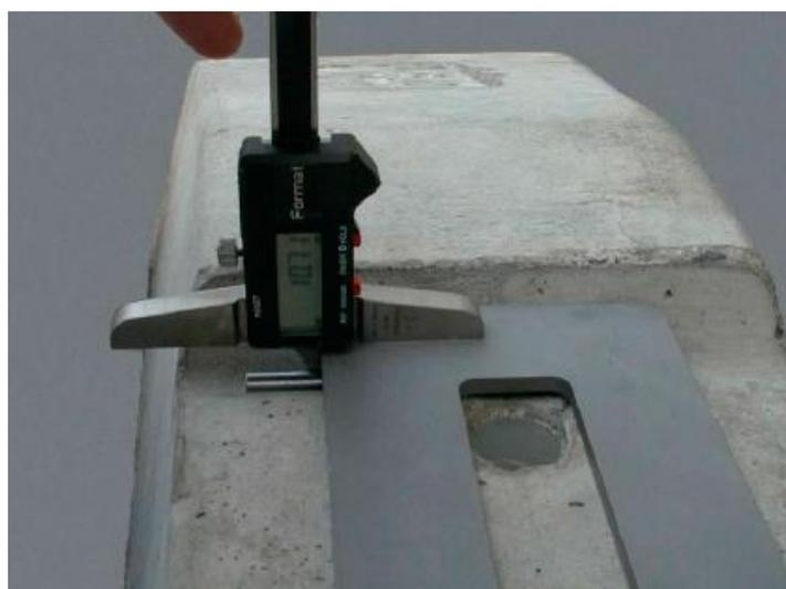
**Figura 13- Medición de profundidad del hombro**
