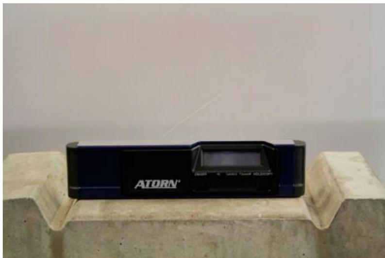
**Figura 6- Medición de inclinación de la zona de apoyo del riel**
