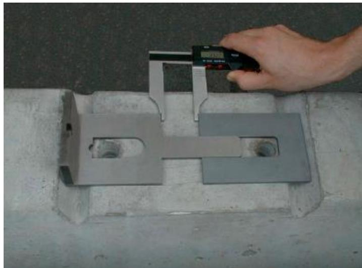
**Figura 8- Medición de distancia entre los hombros internos del riel**
