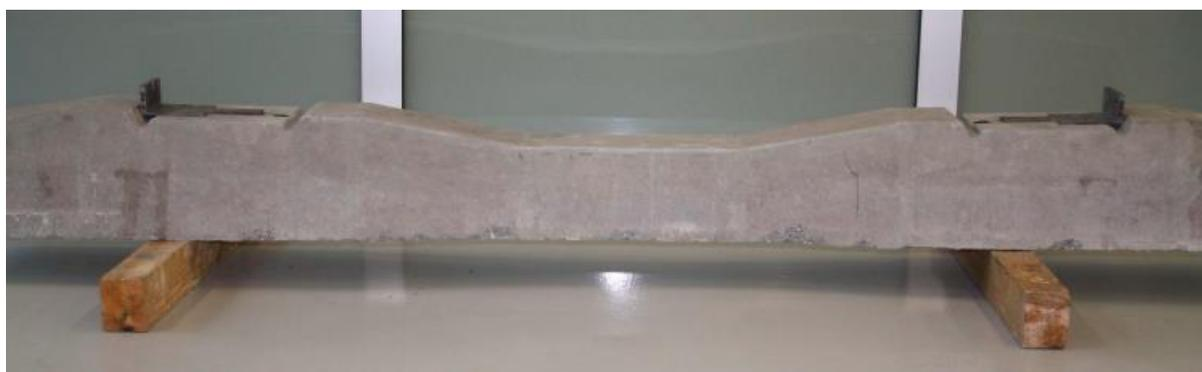
**Figura 7–Medición de distancia entre hombros externos de los rieles**
