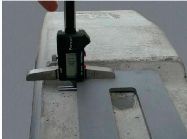
**Figura 19- Medición de profundidad del hombro**
