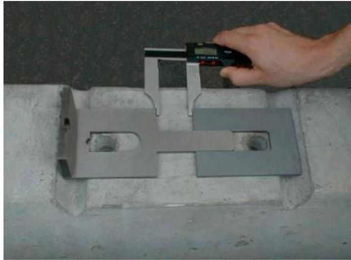
Figura 14- Medición de distancia entre los hombros internos del riel
