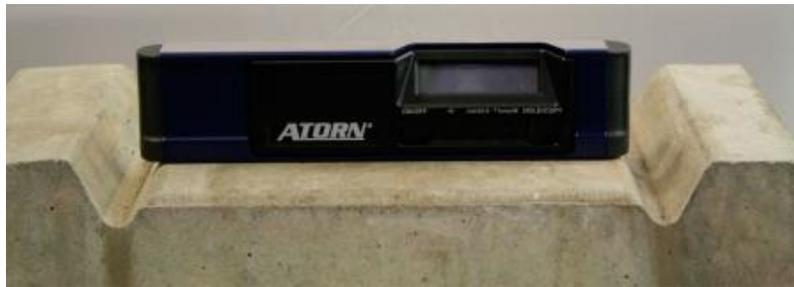
Figura 12- Medición de inclinación de la zona de apoyo del riel
