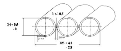
El diámetro interno mínimo de una sección de cualquiera de los tres ductos deberá ser de 34,0 +/- 0,5 mm, con un espesor de pared de 3,0 +/- 0,3 mm en cualquier punto.
