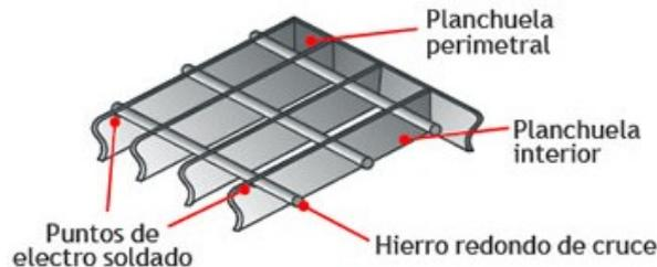
Se acepta como alternativa utilizar malla Shullman pesada galvanizada en caliente de chapa de acero. Los paneles están conformados por un entramado de planchuelas de 25 mm de altura y 2 mm de espesor, cada 60 mm y por hierros redondo de cruce de 6 mm de diámetro, cada 130 mm. Con planchuela perimetral de 25,4 mm de altura x 3,17 mm de espesor, soldada en cada punto de unión para lograr mayor resistencia.
