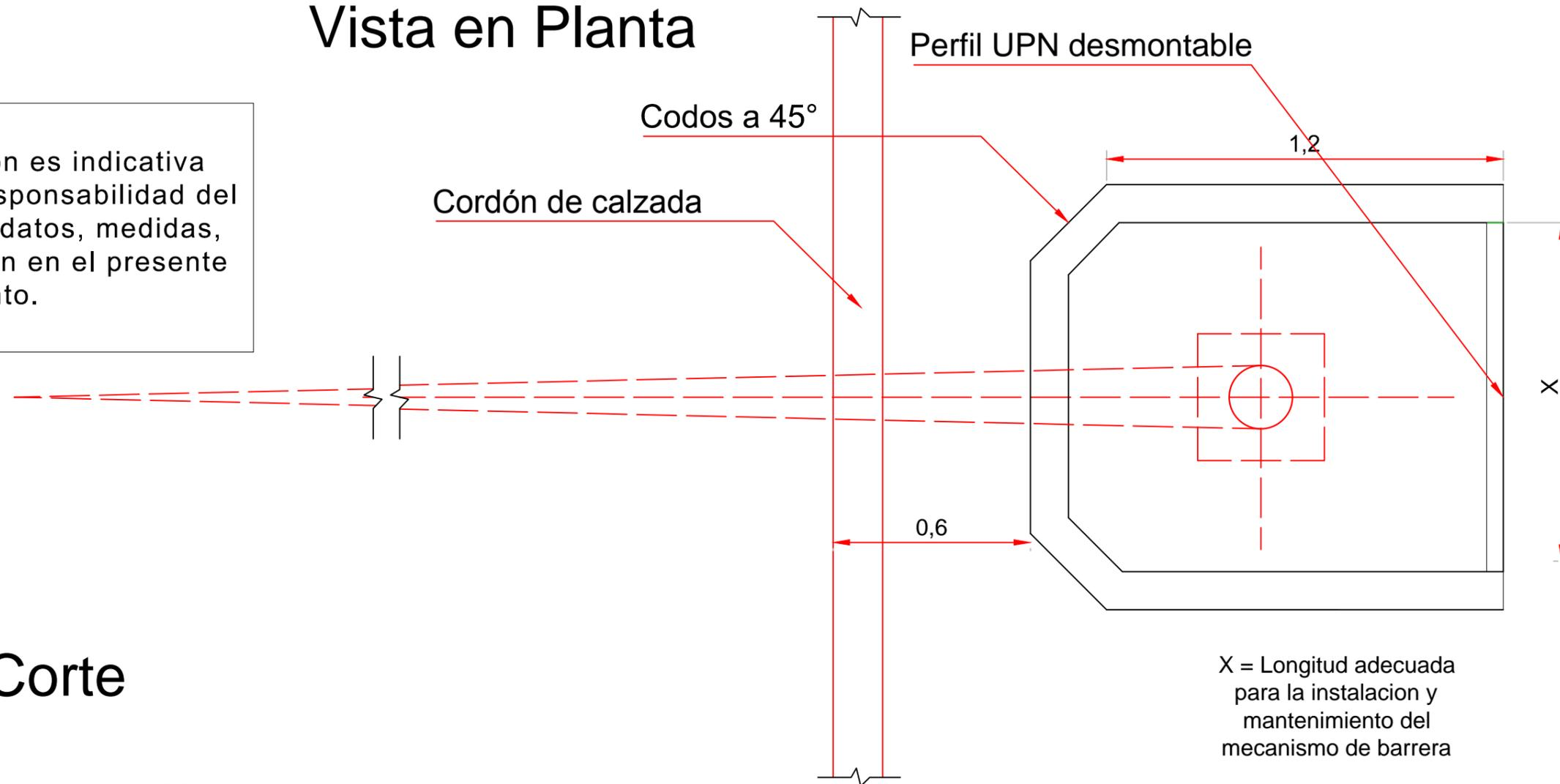
X = Longitud adecuada para la instalación y mantenimiento del mecanismo de barrera
